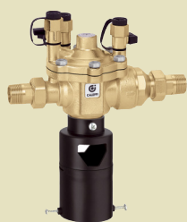
Dränerande återströmningsskydd (BA) Ett skyddsdon med två backventiler och en mellanliggande kammare med hydrauliskt styrd dränering. Kontrollerbara tryckzoner. Används till lantbruk, campingar och andra verksamheter som innebär större risk än vid vanlig hushållsanvändning. Ungefärligt mått vid DN32 320x160x280 mm.
