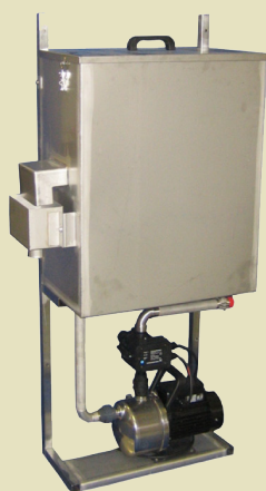
Återströmningsskydd (AB) med luftgap och icke cirkulärt bräddavlopp (fritt). Används till spolningsarbeten i reningsverk. Ungefärligt mått 1400x650x370 mm.
