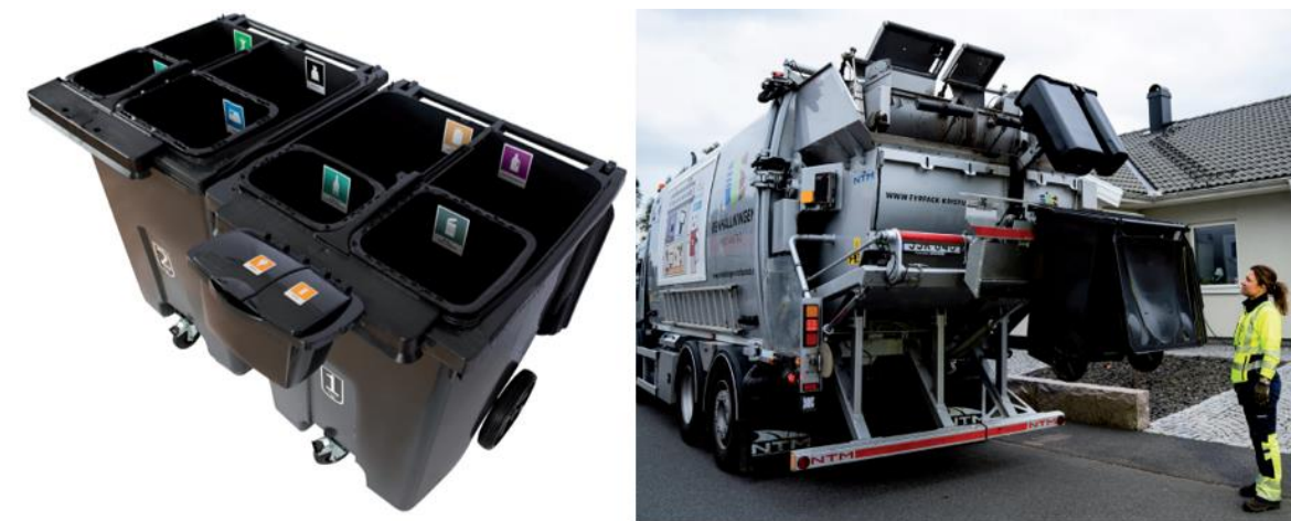
Figur 2. Två stycken 370-literskärl med fyra fack. Sopbil som tömmer ett fyrfackskärl (PWS Nordic AB, 2023).
