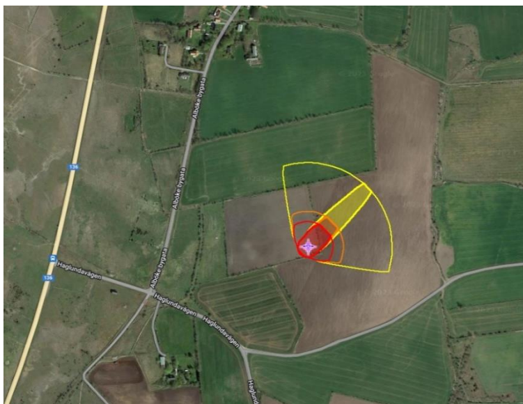
Figur 10 - spridning av gasmoln från avdunstande pöl vid mycket stabil skiktning (F), vind 2 m/s. Röd färg återger avstånd till LEL, orange färg 60 % av LEL och gul färg 25 % av LEL
