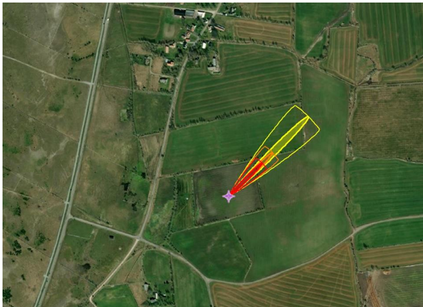
Figur 8 - spridning av gasmoln vid relativt stabil skiktning (D), vind 6 m/s. Röd färg återger avstånd till LEL, orange färg 60 % av LEL och gul färg 25% av LEL
