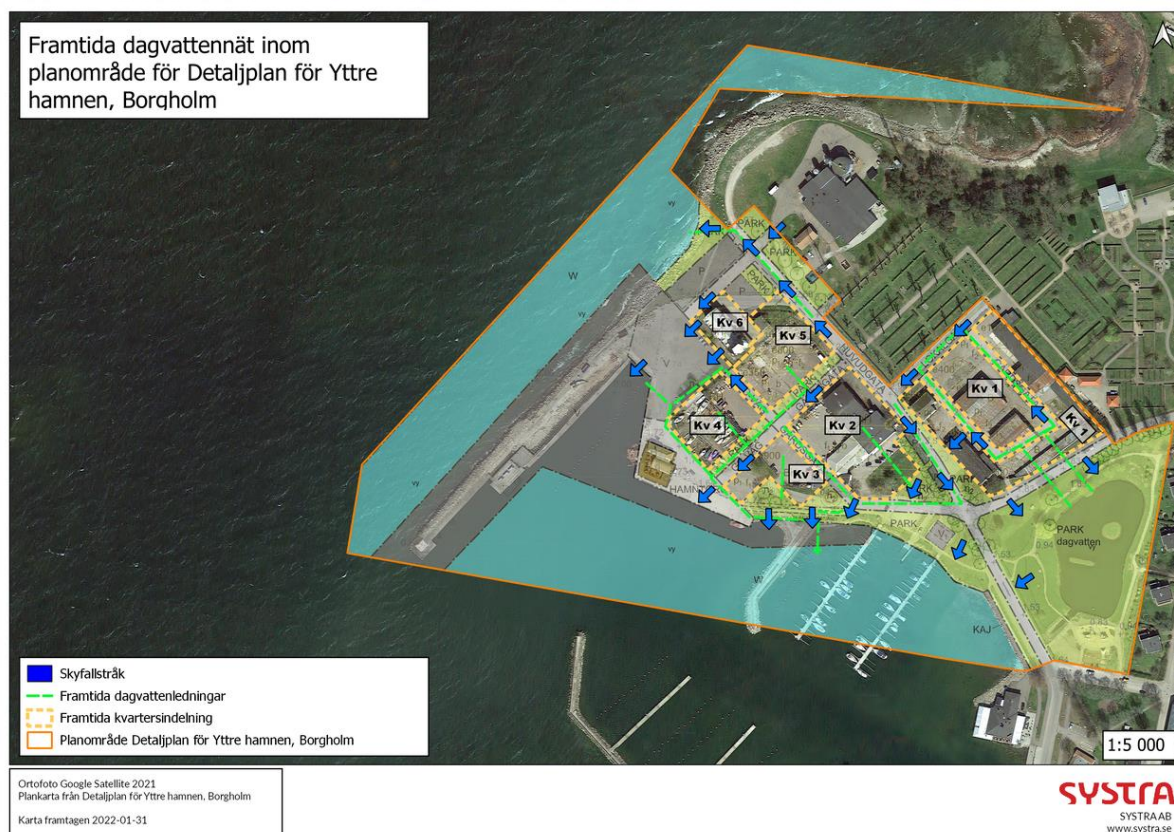
Figur 20. Illustrationen visar principiellt omhändertagande av dagvatten inom planområdet i allmän platsmark. Blå pilar redovisar skyfallsstråk, det vill säga hur vatten avleds vid häftiga regn.
