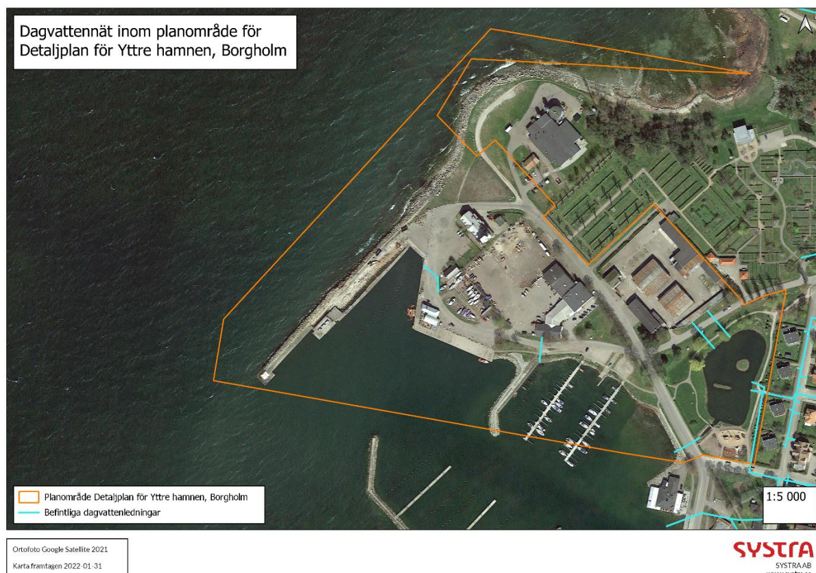
Figur 18. Befintliga dagvattenutlopp inom planområdet redovisas med blå linjer.
