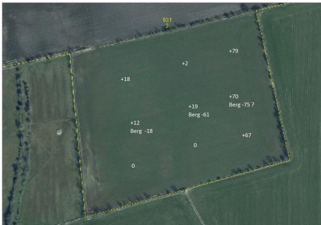
Figur 27. Provgropsgrävning med jorddjup. I punkten Berg -75 finns en viss osäkerhet. Uppskattat jorddjup är minst 75 meter. Kartunderlag hämtat från SGU.
