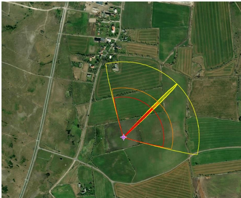
Figur 7 - spridning av gasmoln vid relativt stabil skiktning (F), vind 2 m/s. Röd färg återger avstånd till LEL, orange färg 60 % av LEL och gul färg 25% av LEL
