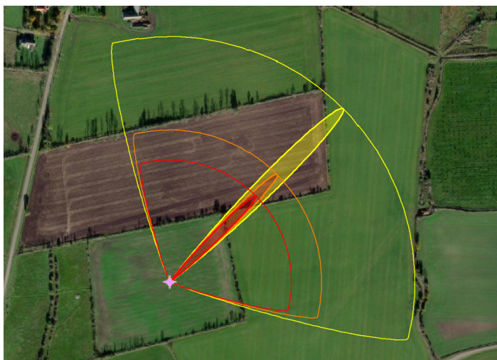
Figur 12. Områden där gasen riskerar att skada personer efter minst 15 minuters exponering. Röd zon: Dödsfall - 400 000 ppm, orange zon: Allvarlig skada - 230 000 ppm, gul zon: Lindrig skada - 65 000 ppm
