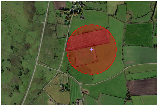
Figur 15. Zon inom vilken värmestrålningen vid en BLEVE är 30 \text{ kW/m}^2 eller högre.
