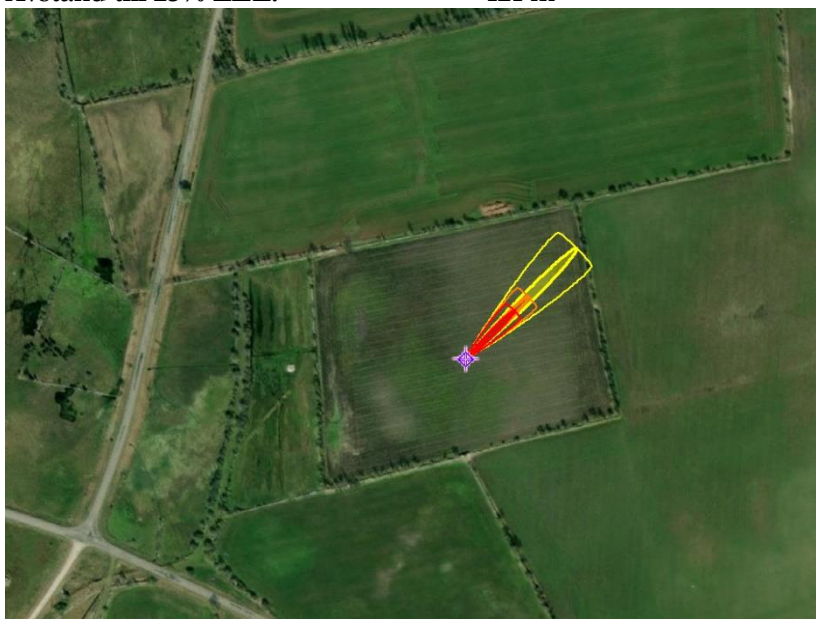
Figur 6 - spridning av gasmoln vid relativt stabil skiktning (D), vind 6 m/s. Röd färg återger avstånd till LEL, orange färg 60 % av LEL och gul färg 25% av LEL
