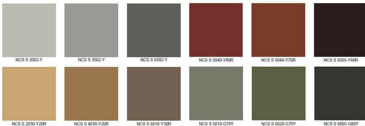
Bild 22. Exempel på passande kulörer med mer än 20 % svarthet ( s =svarthet, 20 %). Falurödfärg har 50 % svarthet enligt NCS systemet (S 5040-Y80R).
