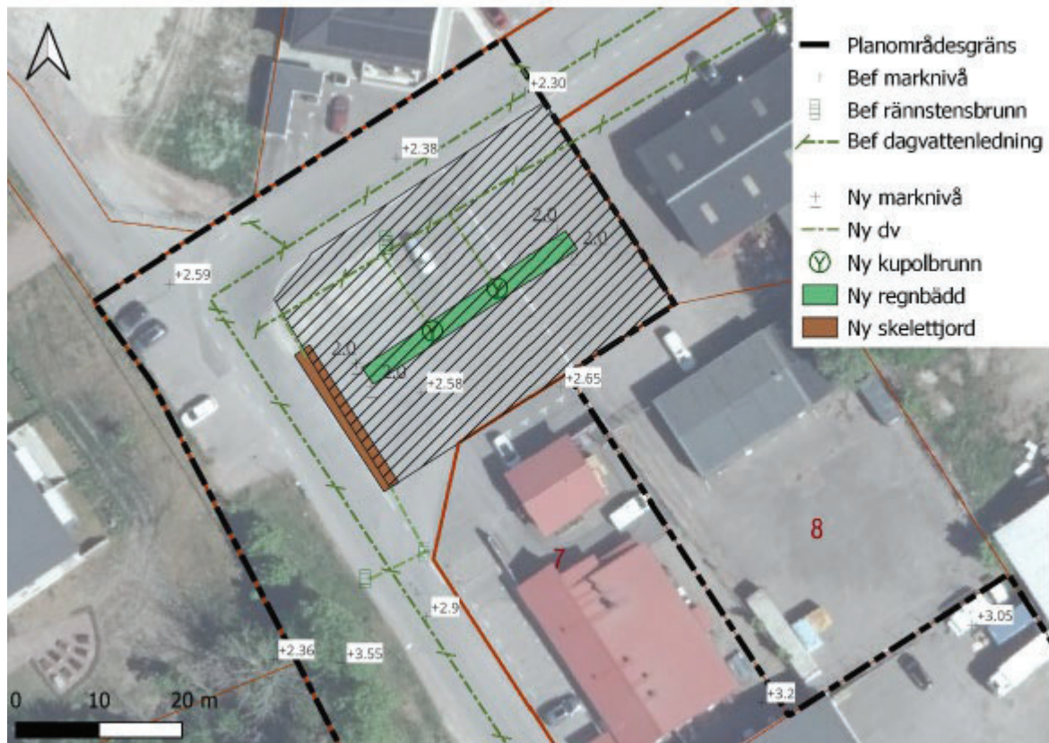
Figur 19. Föreslagen dagvattenhantering i de norra och lägsta delarna av planområdet.
