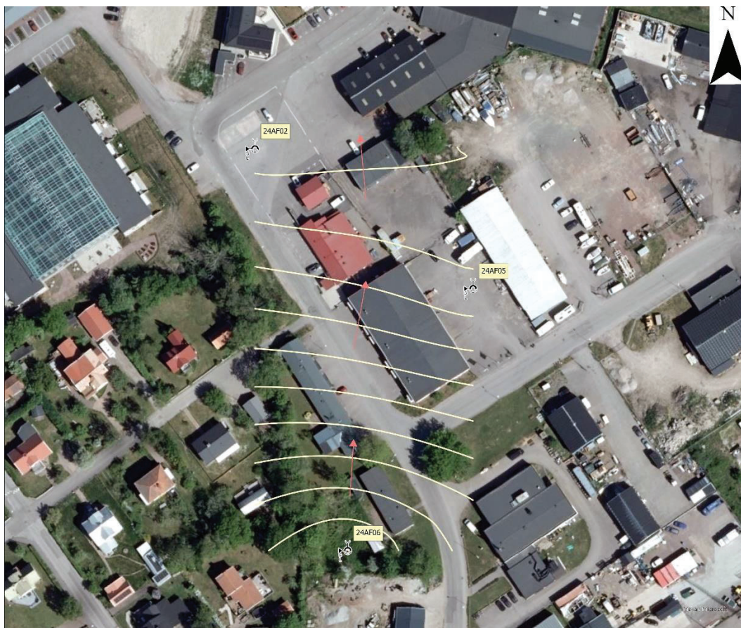
Figur 9. Visualisering av grundvattnets strömningsriktning enligt erhållna grundvattennivåer i de tre grundvattenrören i punkt 24AF02, 24AF05 och 24AF06. Strömningsriktningen bedöms vara åt norr.
