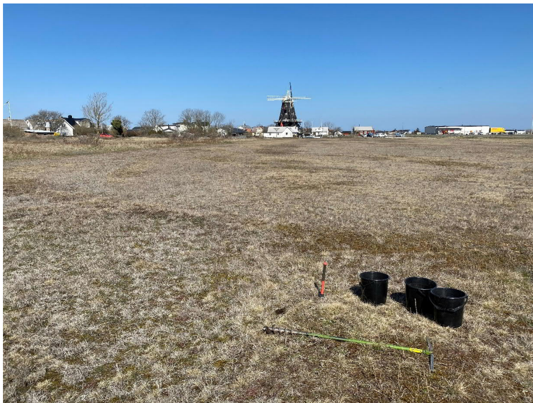
Figur 2. Skruvprovtagning på alvarmark. Foto: WSP
