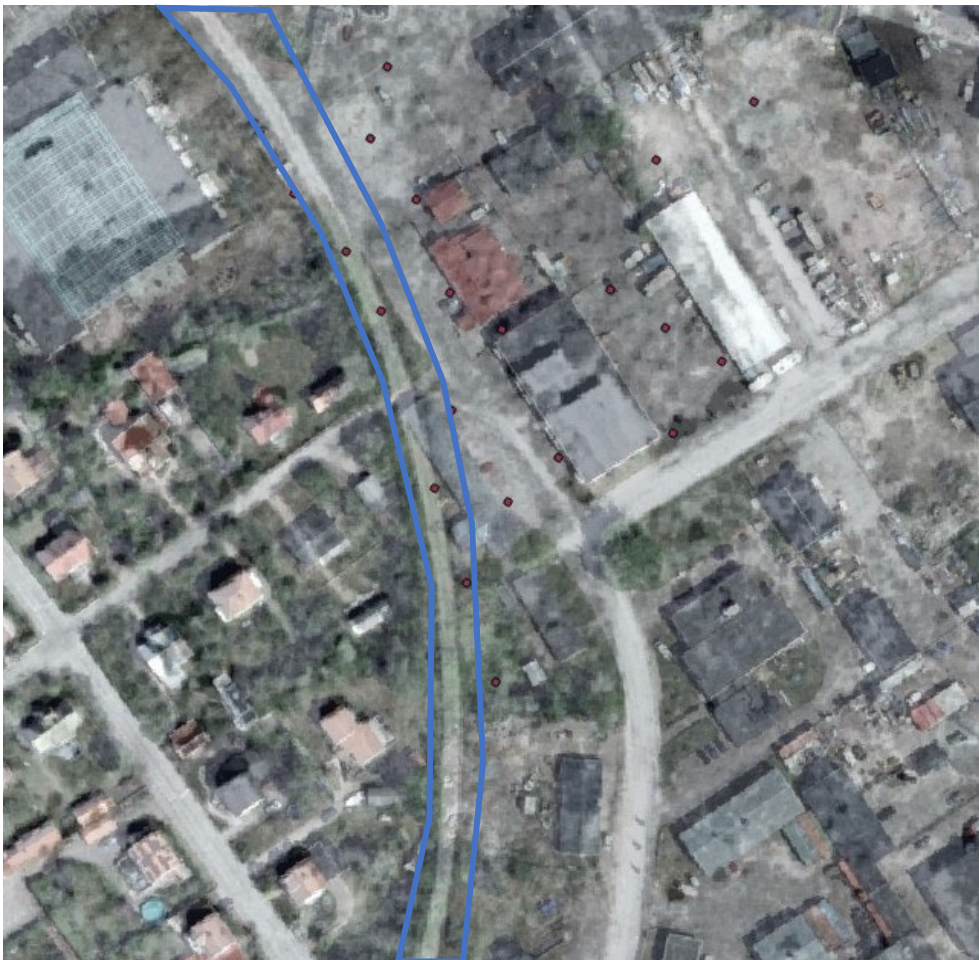
Figur 11. På flygfoto från ca 1960 syns banvallen tydligt, se blå markering. De röda prickarna illustrerar var provpunkterna för det första skedet av den översiktliga miljötekniska utredningen har utförts.
