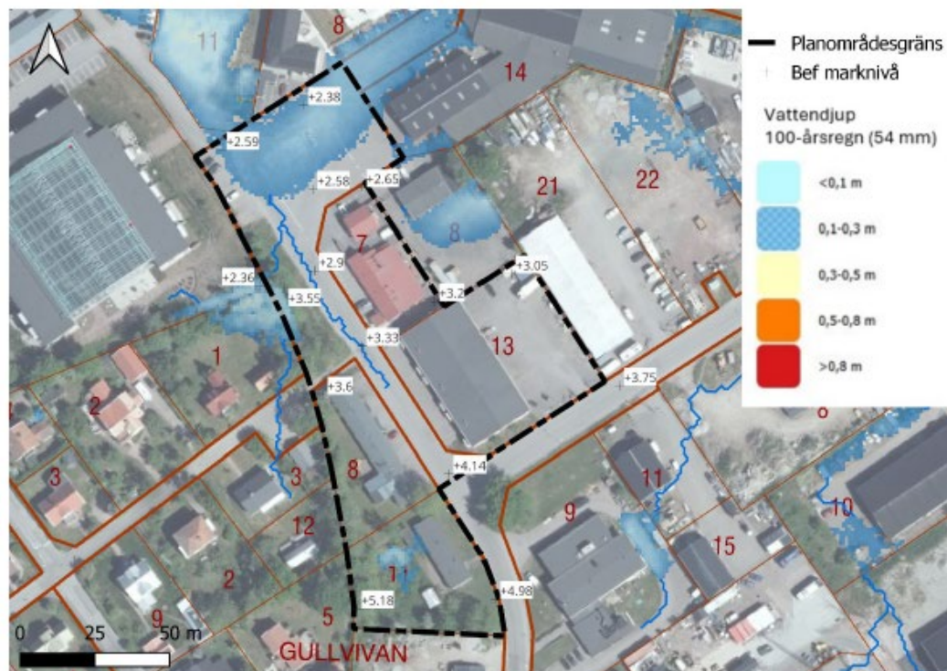
Figur 10. Skyfallsanalys. Vattendjup vid ett klimatkompenserat 100-årsregn motsvarande 54 mm nederbörd samt avrinningsvägar med ett uppströms avrinningsområde > 6000 m 2 .
